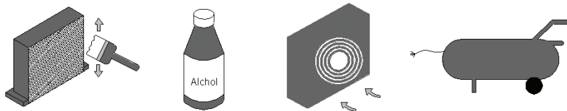
Figura 6 La limpieza del condensador
