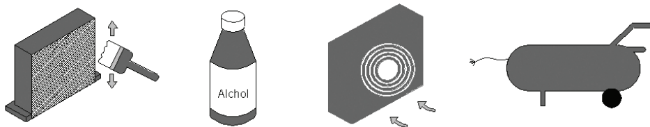
Figure 6 Nettoyage du condenseur
