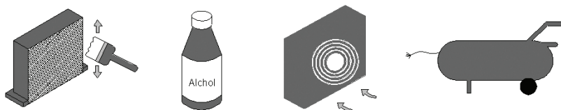
Figura 6 Pulizia del Condensatore
